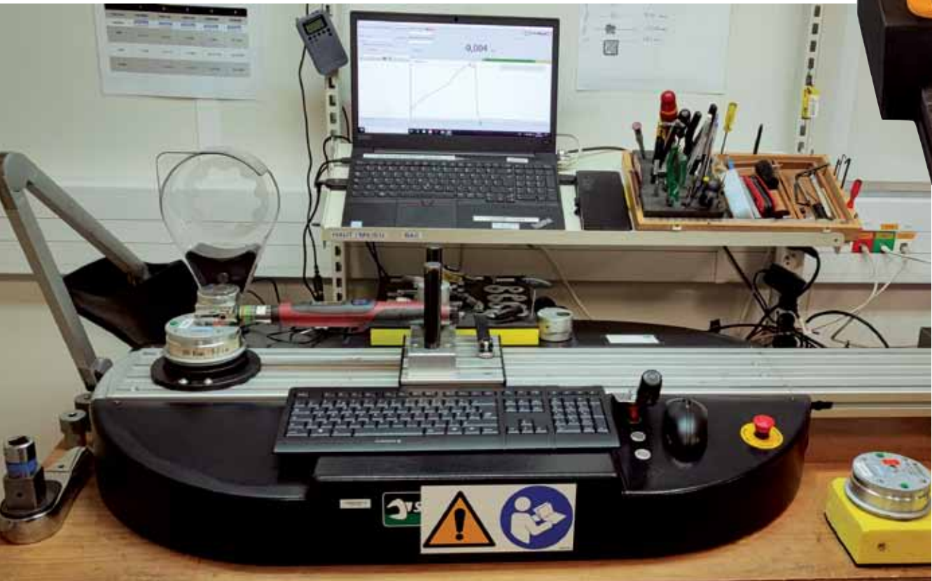
Banc de couple pour le contrôle des clés dynamométriques.
