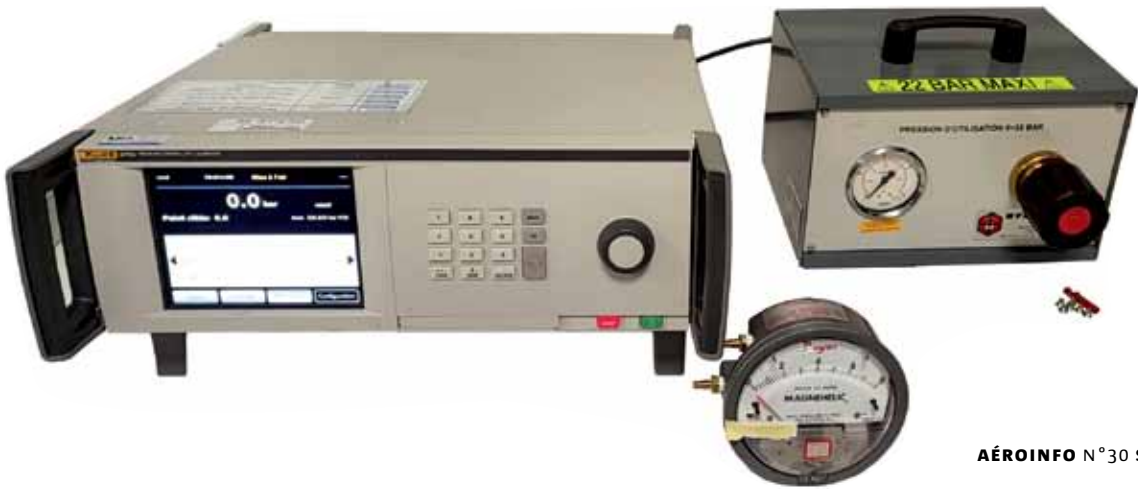
Contrôleur de pression pour les manomètres.
