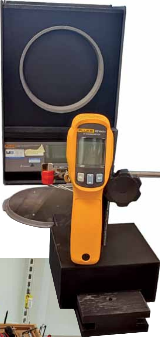
Corps noir pour le contrôle des thermomètres infrarouges.
